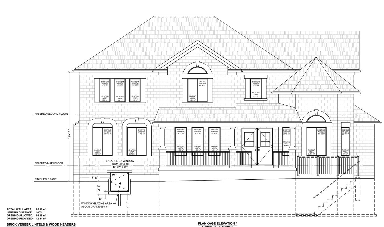
FLANKAGE ELEVATION / NORTH ELEVATION
